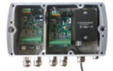
3 Capteur d'inclinaison dans le boîtier de raccordement
