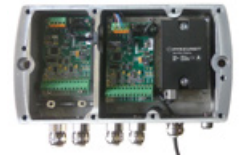
3 Neigungssensor in Klemmkasten
