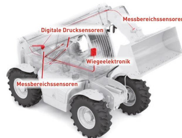
Noch schneller und einfacher wiegen Sie mit Speed Weigh Technology (SWT):
