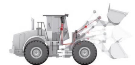
Noch schneller und einfacher wiegen Sie mit **Speed Weigh Technology (SWT)**: Digitale Winkelsensoren ermöglichen eine Erweiterung des bisherigen Messbereichs. Eine Gewichtsanzeige erfolgt bereits nach kurzem Hub.
