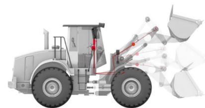
Noch schneller und einfacher wiegen Sie mit **Speed Weigh Technology (SWT)**: Digitale Winkelsensoren ermöglichen eine Erweiterung des bisherigen Messbereichs. Eine Gewichtsanzeige erfolgt bereits nach kurzem Hub.
