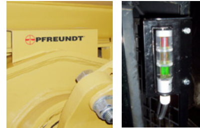
2 Messelement DW-3 mit LED Ladeampel
